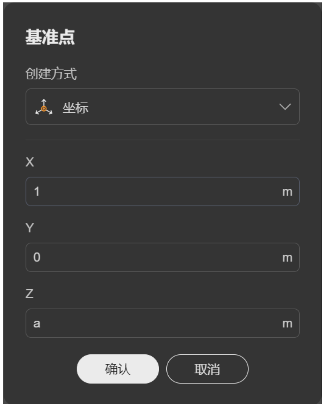
图 2-18 通过坐标创建基准点
