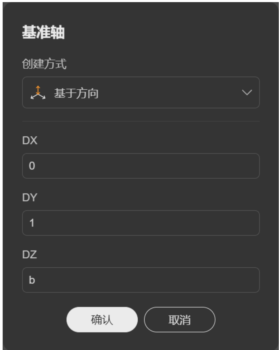
图 2-23 根据方向创建基准轴
